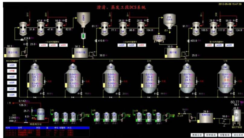
图5 澄清、蒸发工段控制系统
