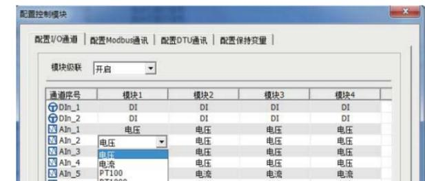
(1) 结构紧凑，适用于供热自控系统。它通过I/O通道，输入数字量和模拟量、模拟输出和数字输出与现场仪表相连，I/O数可通过控制器级联来满足工程的要求。
